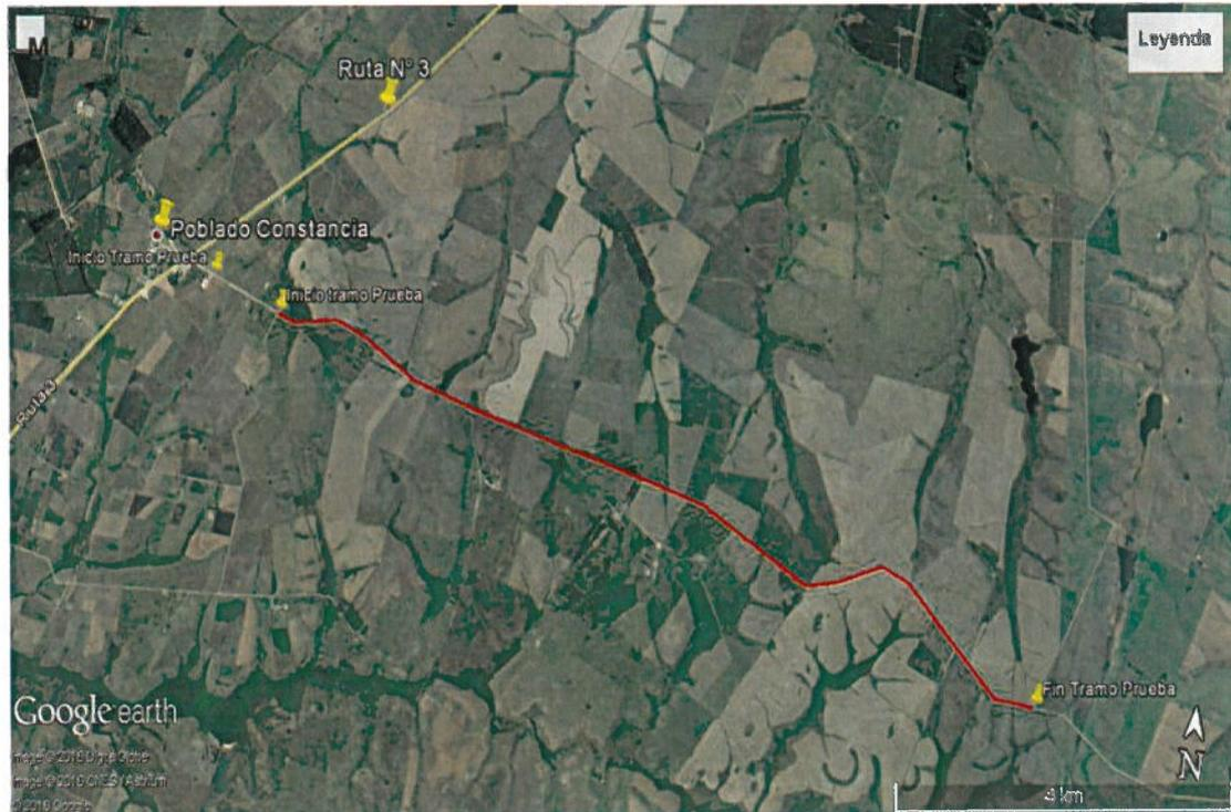
Dicho tramo, fue segmentado en 8 sub- tramos de 1; 1,5 y 2 Km sobre los cuales se realizaron 2 tramos testigo y 6 tramos con aplicaciones de productos estabilizantes de suelo, los cuales otorgan (por diferentes vías de acción) mayor durabilidad a la estructura de base.
